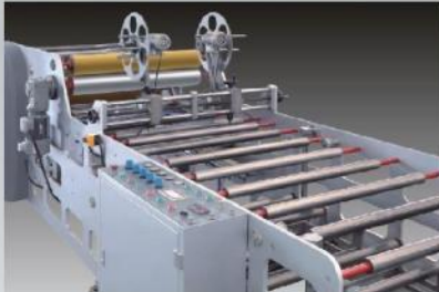
自动双工位换卷 Automatic roll change rewinder
